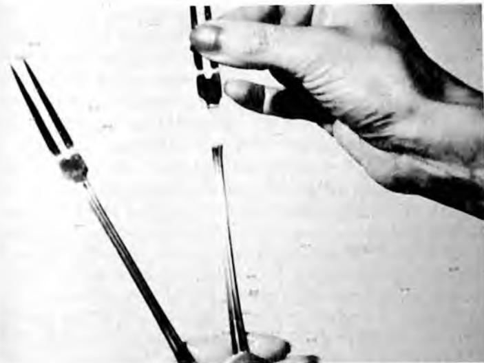
42 Aluminiumgabel, die in zwei Stücke zersprang
