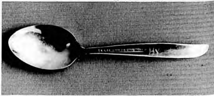
17 Teelöffel axial gedreht durch Schleuderbewegung im „Plastikzustand“, ausgeführt von Hiroto Yamashita (Geschenk von Prof. W. Uphoff)
