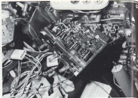
Abb. 19 Steckplatten, Bildröhrenhals u. a. zeigen sich gebrochen, was laut Radiofachmann und Schleuderversuch mit Steckplatten nur durch Einwirkung von innen möglich ist.
